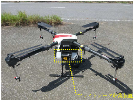
写真3 散布用ドローン TEAD TA408
