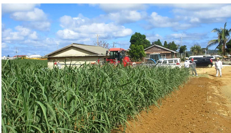
ハイクリアランスブームスプレーヤのGNSS自動操舵散布作業
